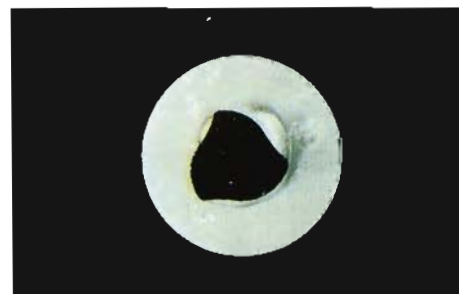
Fig. 3 - Vista trasversale ottenuta con luce polarizzata al M.O. (x40). Notate l'importanza dell'anima residua che garantisce massima sicurezza nella dinamica della rotazione continua.
